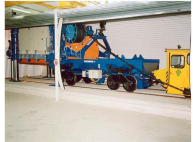
Demonstration der Einlagerung (oben) und der Wiederaufnahme (unten) von POLLUX®-Behältern
