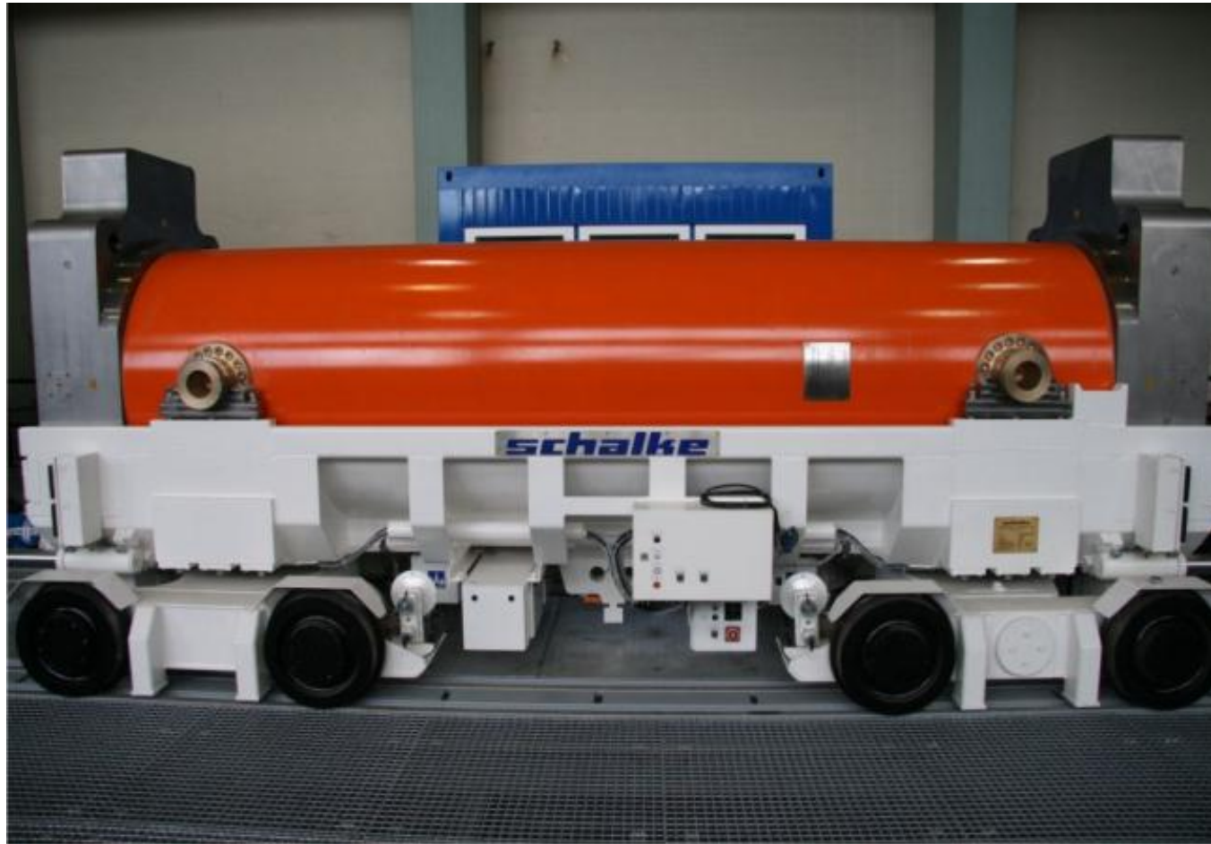
Foto: Plateauwagen mit Transferbehälter für die vertikale Bohrlochlagerung von Brennstabkokillen
