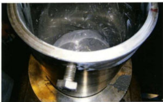
Abbildung 3 Auspressvorrichtung der GRS mbH mit Verfüllmaterial des Typ B-Felds vor dem Einsetzen des Druckstempels
