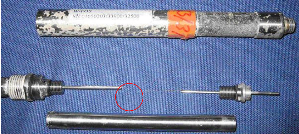
Fig. 3.33 W-FOS 3 with broken Parameter grating
