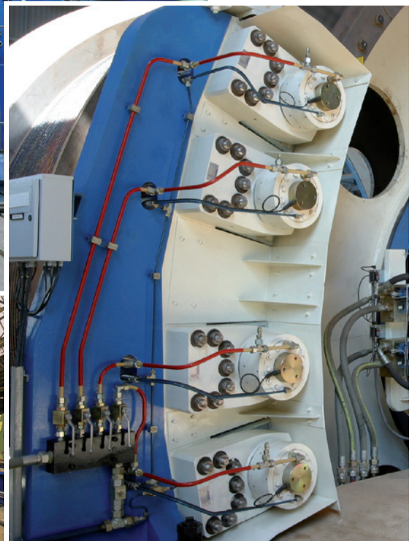
Scheibenbremse mit BE 200-Elementen für eine Trommel-Fördermaschine
