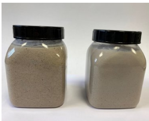
Abbildung 59: Linke Mischung: Sorelbeton ohne Anhydritmehl, rechte Mischung: mit Anhydritmehl (8% zusätzlich) [20]
