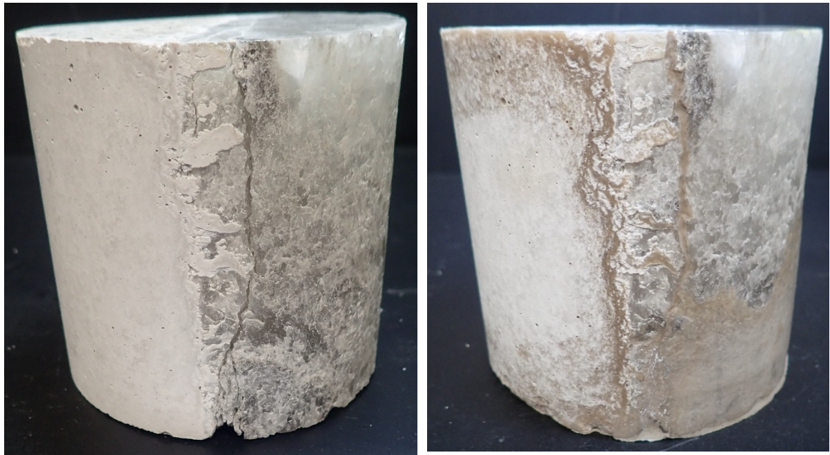
Abbildung 46: Links vor Injektion / rechts nach Injektion
