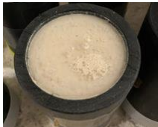
Abbildung 52: Überstandslösung auf einem Probekörper nach einem Tag.
