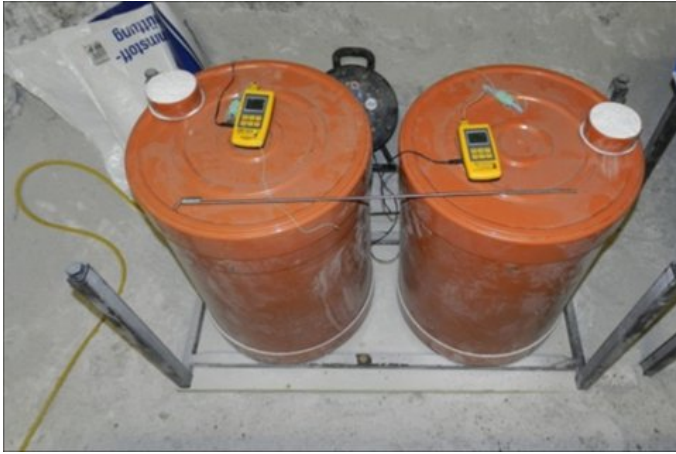
Abbildung 56: Quasiadiabatisches Kalorimeter im untertägigen Einsatz
