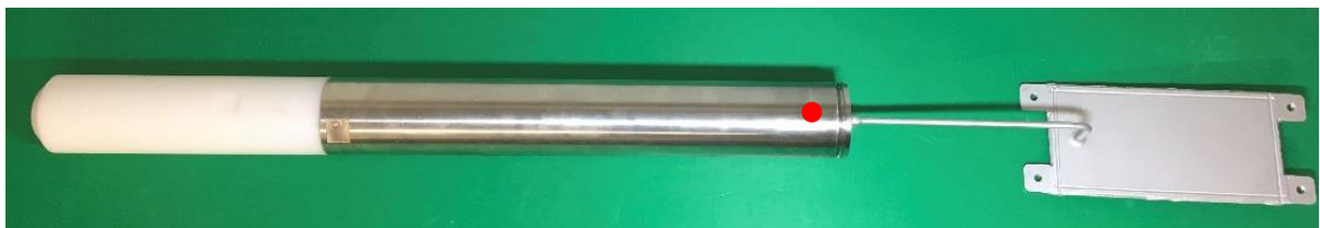
Abbildung 28: Plattendruckaufnehmer (rechts) mit kabelloser Datenübertragungseinheit (KLS), die Lage des Temperatursensors ist rot markiert
