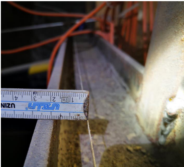
Abbildung 74: Mittige Durchbiegung des 3. I-Trägers
