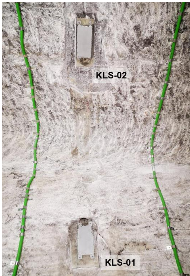
Abbildung 34: KLS-01 auf der Sohle und KLS-02 am SE-Stoß zwischen den vertikalen Injektionsringen
