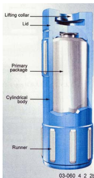
Abbildung 4-2: Endlagercontainer für verglasten HAW
