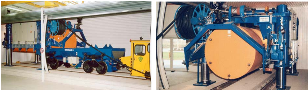
Abbildung 5-28: Fotos von Demonstrationsversuchen mit der Einlagerungstechnik für POLLUX-Behälter (links: Lokomotive zieht Plateauwagen unter Einlagerungsvorrichtung hervor; rechts: Einlagerungsvorrichtung legt den POLLUX-Behälter auf die Streckensohle)
