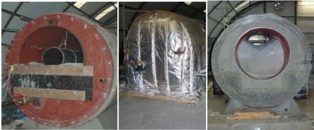
Abbildung 6-17: Demonstrationsversuche zur Zementverfüllung einer Einlagerungsstrecke: Behältermodell mit zentralem Erhitzer (links) und Einschalung (Mitte) sowie Schnitt durch das Modell mit vollständiger Verfüllung der Hohlräume (rechts), Belgien [Bel 2006].
