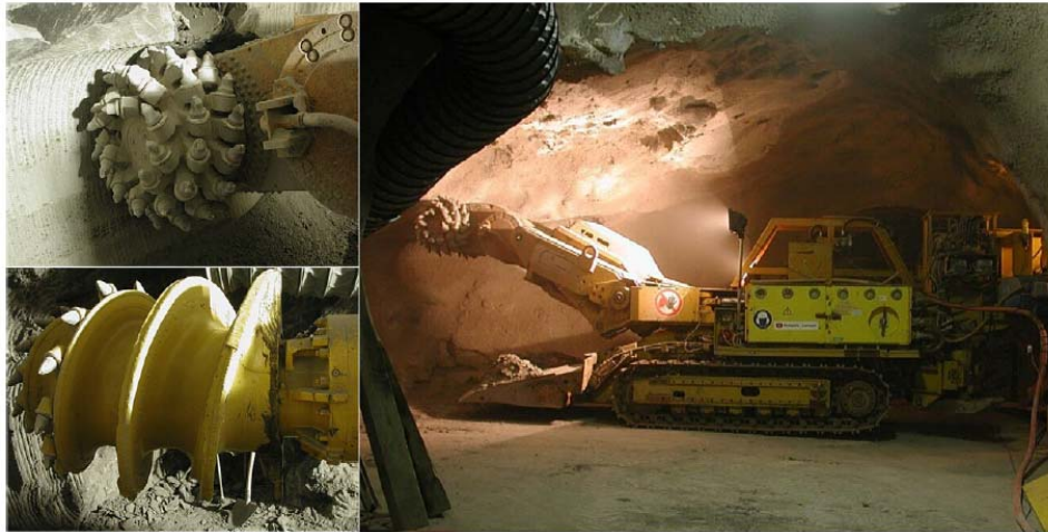
Abbildung 6-7: Teilschnittmaschine, links verschiedene Schneidköpfe [NAGRA 2002a].
