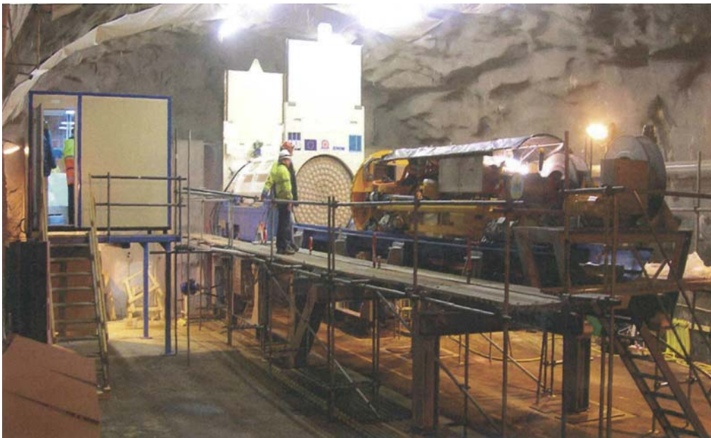
Abbildung 6-14: Einlagerungsmaschine mit Wasserkissentechnologie für die Einlagerung in horizontale Bohrlöcher (Untertage-labor Äspö, Schweden) [Pettersson 2006c]
