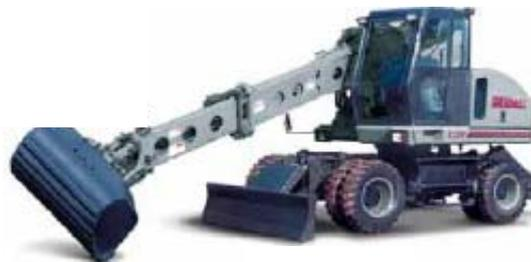
**Abbildung 4-7: Bagger mit Telekoparm, der auch mit einer Verdichterplatte ausgerüstet werden kann /4-6/**
