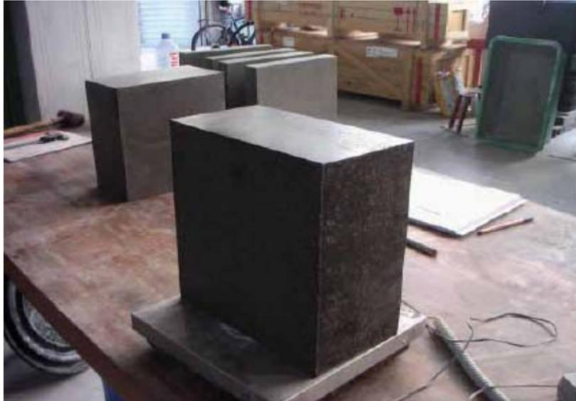
**Abbildung 4-6: Testblöcke aus Bentonit /4-6/**
