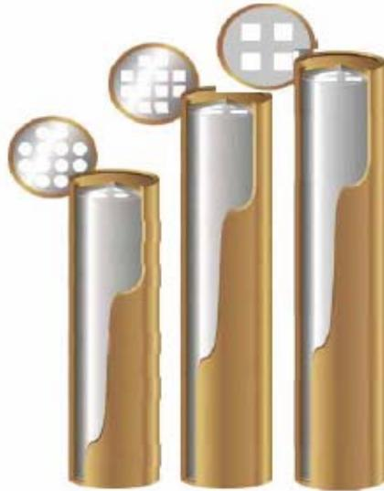
**Abbildung 4-5: Finnland – Varianten von kupferummantelten Behältern für ausgediente Brennelemente (von links nach rechts): BWR-BE, VVER 440-BE und EPR-BE /4-4/**
