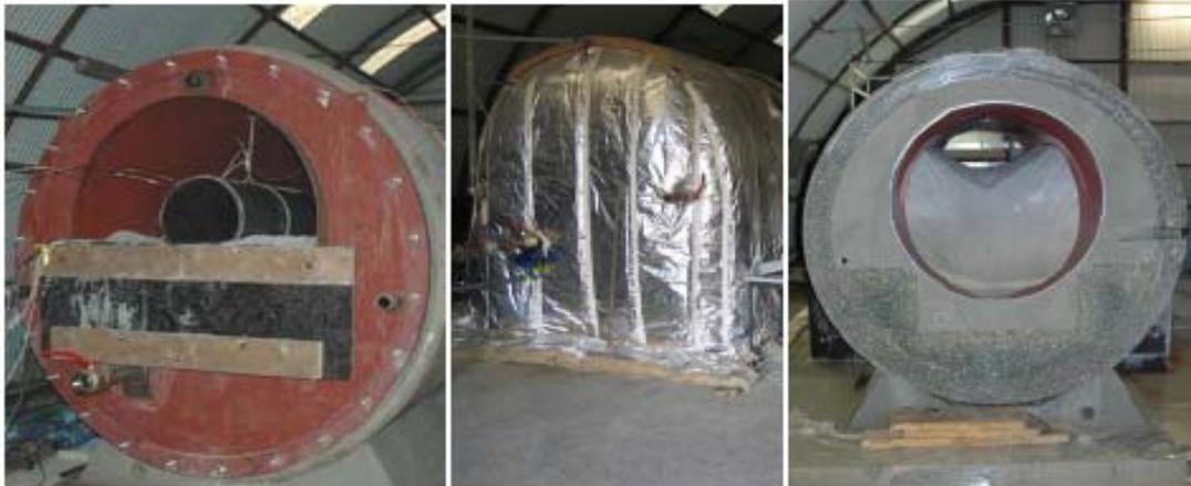
**Abbildung 3-9: Test zur Zementverfüllung: Behältermodell mit zentralem Erhitzer (links) und Einschalung (Mitte). Nach Abschluss des Pumpversuches zeigt ein Schnitt durch das Modell die vollständige Verfüllung der Hohlräume mit Zement (rechts).**
