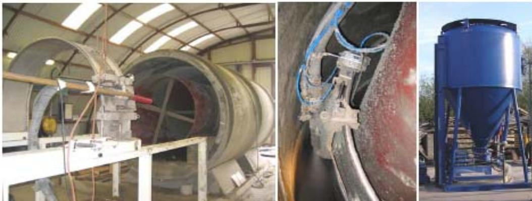
**Abbildung 3-8: Test zum Einblasen trockener Verfüllmaterialien: Verblas-Fahrzeug (links und Mitte) und Vorratsbehälter der Verblasmaschine (rechts) /3-27/**
