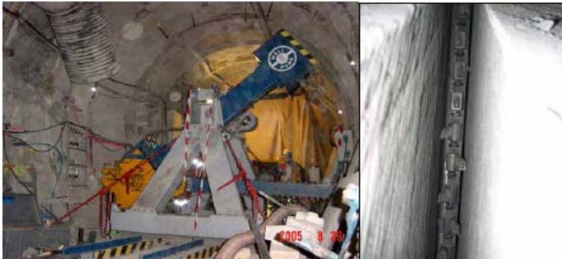
**Abbildung 3-22: Großversuch zur Erstellung von Schlitzen zur Unterbrechung der Auflockerungszone (KEY-Versuch) im Untertagelabor in Bure (Frankreich) /3-29/**
