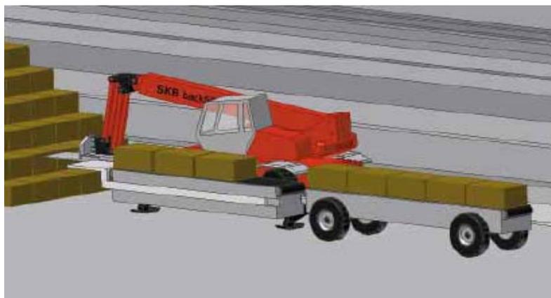
**Abbildung 4-8:** Streckenverfüllung mit Bentonitblöcken durch einen Kranwagen mit einer Gabel am Hydraulikarm /4-6/
