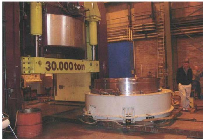
**Abbildung 4-19: Fertigung von Bentonitringen /4-47/**
