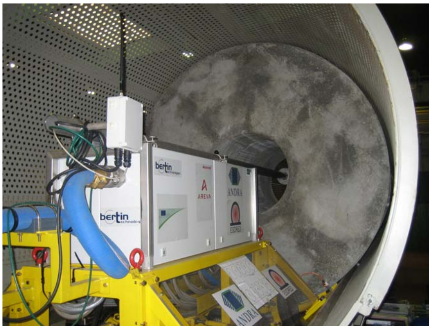
Abbildung 5-19: Großversuch zum Einbringen von Bentonitringen in Großbohrlöcher in Beaumont Hague – Frankreich /5-3/
