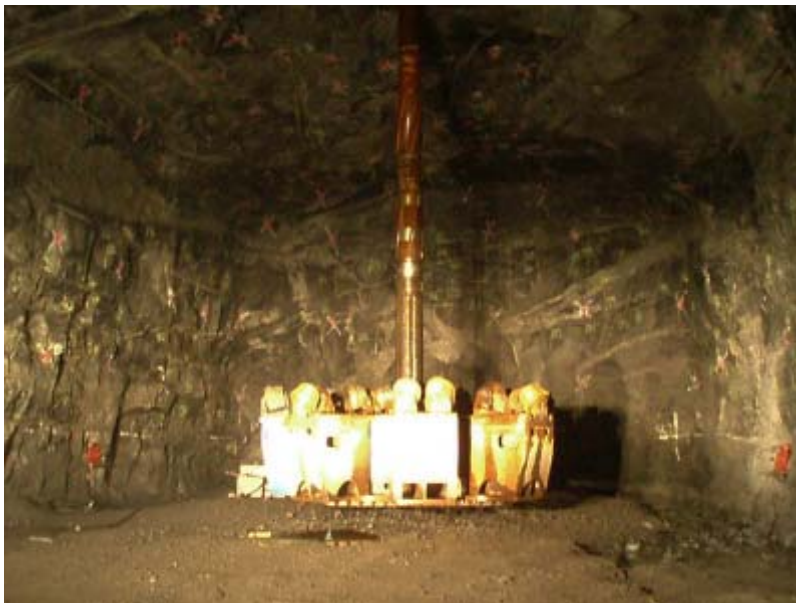
Abbildung 3-4: Raise-Bohrkronen für die Erstellung des Personenschachtes für das Untertagelabor Onkalo – Finnland /3-13/
