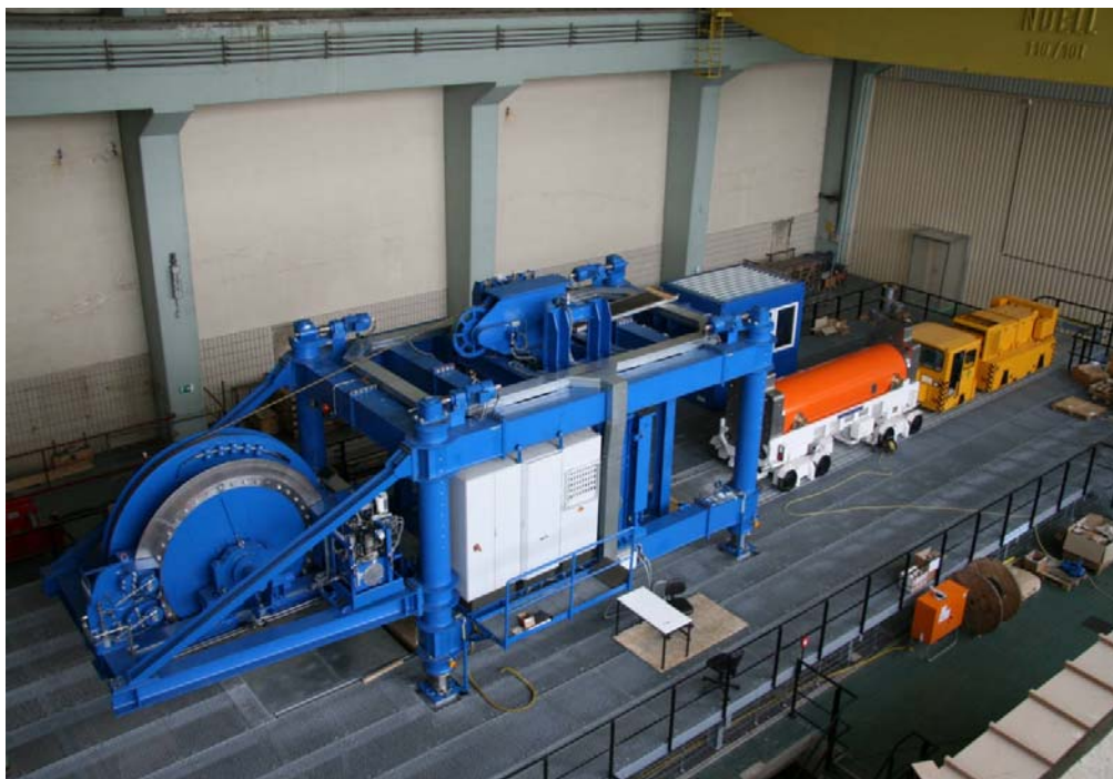
Abbildung 2-19: Prinzipskizze vom technischen Konzept für die Einlagerung von Endlagergebinden in tiefe Bohrlöcher / Foto vom Versuchsstand zur Erprobung der Komponenten im Maßstab 1:1 – Deutschland /2-30/
