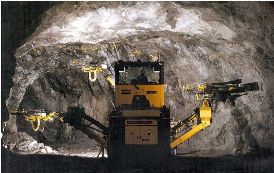
Abbildung 3-22: Bohrjumbo zum Bohren der Löcher für den Sprengvortrieb /3-20/
