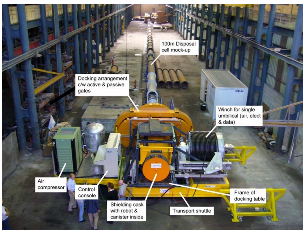
Abbildung 5-15: Versuchsstand zur Einlagerung wärmeentwickelnder Abfälle in St. Chamond – Frankreich /5-1/
