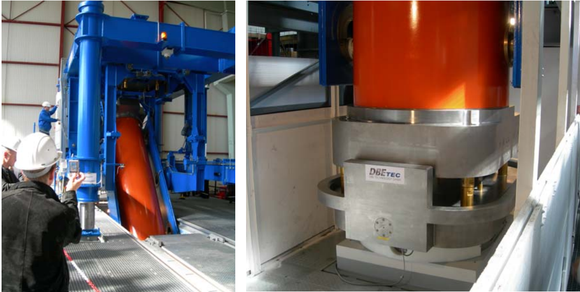
Abbildung 5-51: Demonstrationsversuch zur Bohrlochlagerung von BSK 3-Kokillen in Landesbergen Links Drehen des Transferbehälters mittels Einlagerungsmaschine durch den Bohrlochkeller in eine vertikale Position, rechts Aufsetzen des Transferbehälters auf die Bohrlochschleuse. – Deutschland
