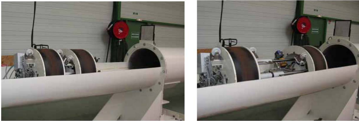
Abbildung 5-14: Schieberoboter Typ 2; links im eingefahrenen und rechts im ausgefahrenen Zustand – Frankreich /2-24/
