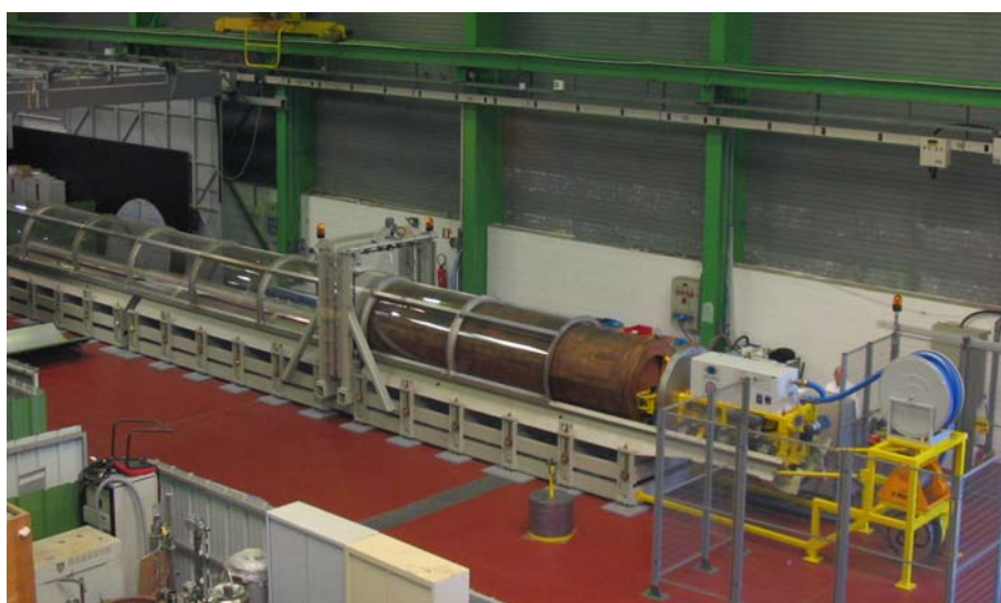
Abbildung 5-23: Demonstrationsversuch zur Einlagerung von Brennelement-Behältern in Beaumont Hague – Frankreich /5-3/
