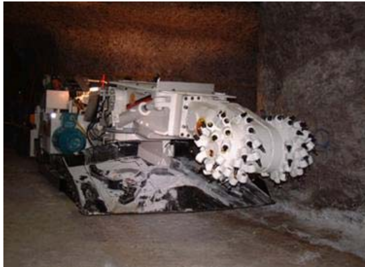
Abbildung 3-12: Teilschnittmaschine mit Querschneidkopf /3-1/
