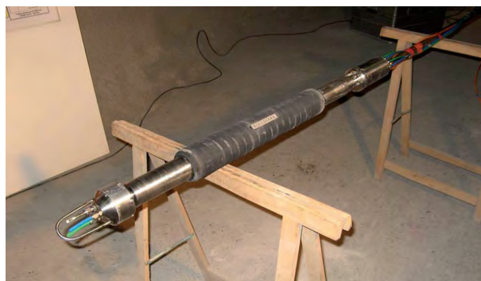
Abb. 71: Schlitzpacker der BGR zur Bestimmung anisotroper Permeabilitäten im Tonstein (Quelle: BGR)
