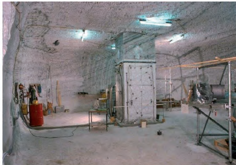
Salzbergwerk Asse II, 750 m - Sohle; Uniaxialer In-situ-Kriechversuch mit einem Druckkissen an einem Steinsalzpfiler (1,5 m x 4,0 m - Tonliniensalz des z2); Versuchszeitraum: 1/1985 - 1/1994 (9 Jahre).
