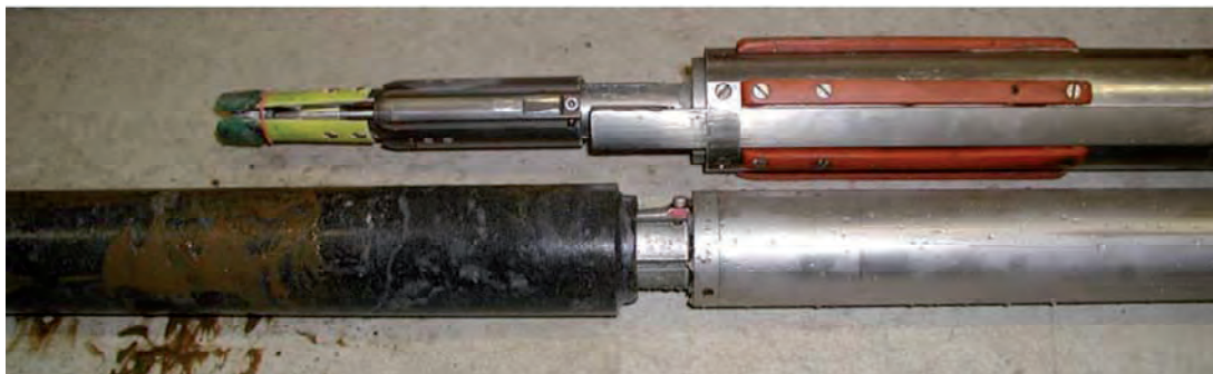
Abb. 43: Gerät zur Durchführung von Überbohrversuchen in tiefen Erkundungsbohrungen zur Ermittlung der Gebirgsspannungen am Standort Olkiluoto, Finnland („Borre probe“, SwedPower, Posiva 2005)
