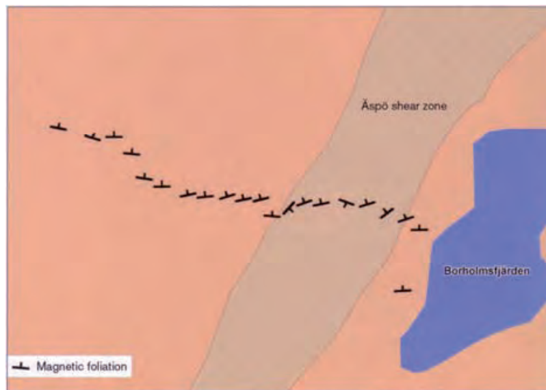
Abb. 39: Abgrenzung einer mächtigen Störungszone im kristallinen Wirtsgestein am potenziellen schwedischen HAW-Endlagerstandort Oskarshamn auf der Grundlage geomagnetischer Untersuchungen (AMS-Methode, SKB 2005a)
