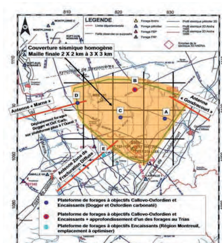
Abb. 27: Lage der im Untersuchungsgebiet Meuse/Haute Marne geplanten tiefen Erkundungsbohrungen zur Analyse der Wirtsgesteine bzw. des Nebengebirges (Bohrungen A bis D) und der Störungszonen (Bohrungen E und F) (Quelle: ANDRA )
