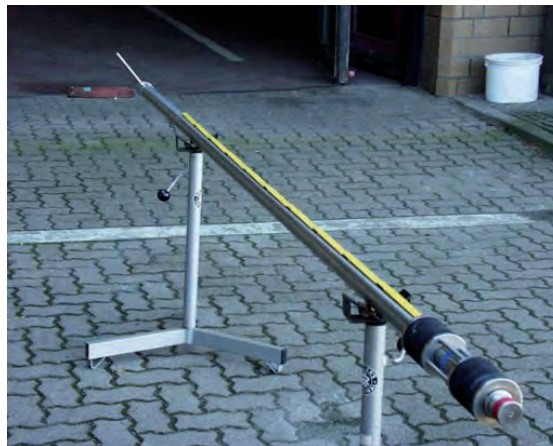
Abb. 88: Kurzintervall-Packer zur Messung von Gesteinspermeabilitäten im Streckennahbereich (Quelle: BGR)
