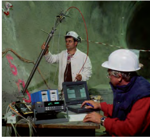
Abb. 53: Durchführung von Permeabilitätsmessungen im Untertagelabor Mont Terri (Quelle: BGR)
