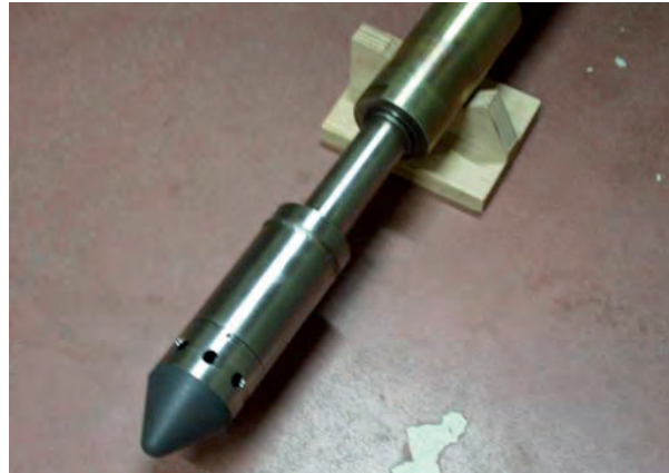
Abb. 69: Packersystem zur Durchführung von Permeabilitätsmessungen im Tonstein (Quelle: BGR)
