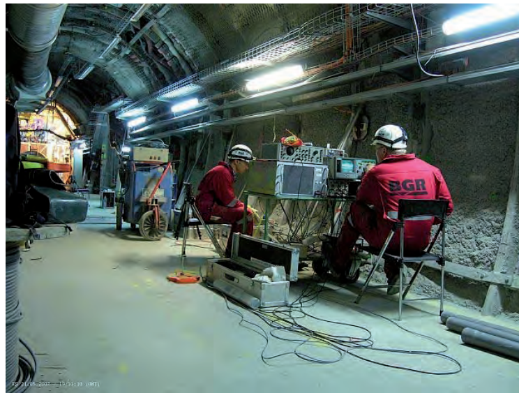
Abb. 78: Durchführung von Ultraschallmessungen zur Erkundung der Auflockerungszone im URL Meuse/Haute Marne (Quelle: BGR)
