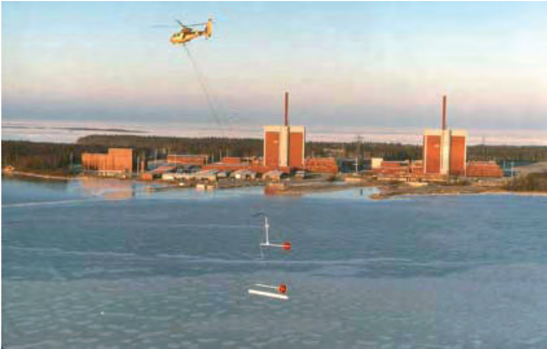
Abb. 34: Einsatz aerogeophysikalischer Messungen bei der geologischen Erkundung des finnischen HAW-Endlagerstandortes Olkiluoto (Mc EWEN & ÄIKÄS 2000)
