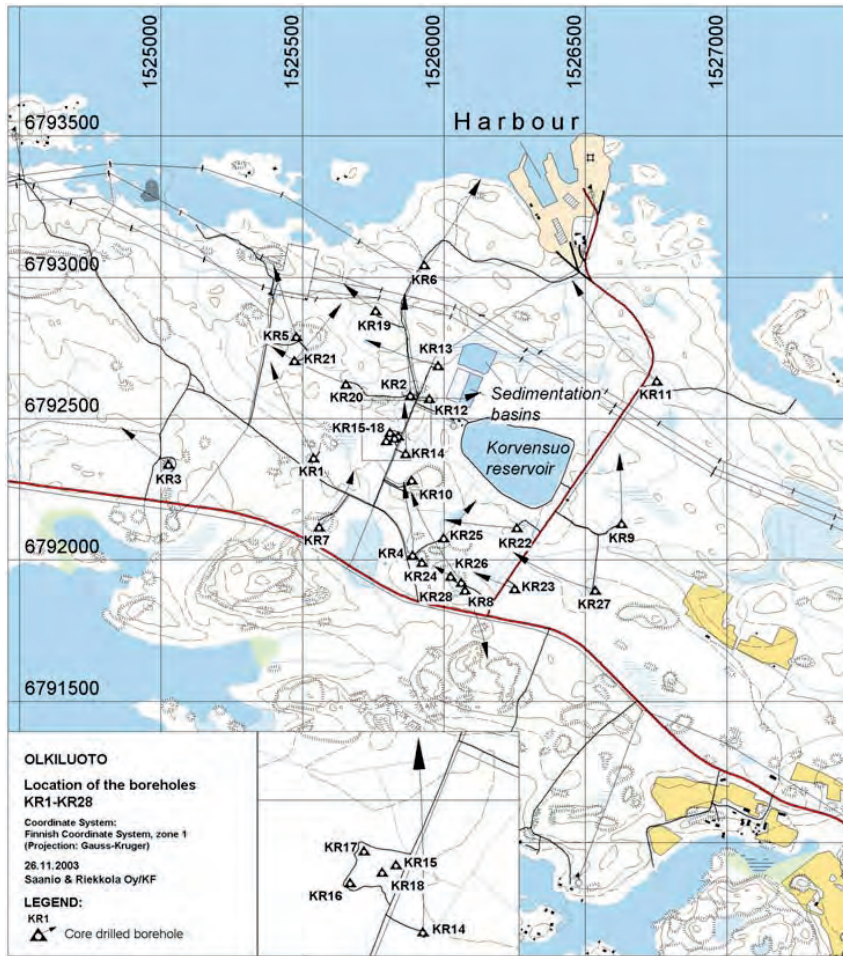
Abb. 35: Anwendung von überwiegend abgelenkten Erkundungsbohrungen zur Lokalisierung und Untersuchung von Störungszone am finnischen Endlagerstandort Olkiluoto (Posiva 2005)
