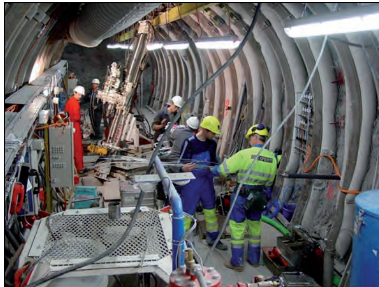
Abb. 79: Durchführung hydraulischer Tests mittels Mehrfachpacker im URL Bure (Quelle: BGR)
