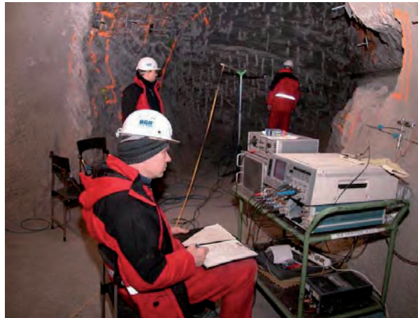
Abb. 49: Durchführung bohrlochseismischer Messungen im Untertagelabor Mont Terri (Quelle: BGR)
