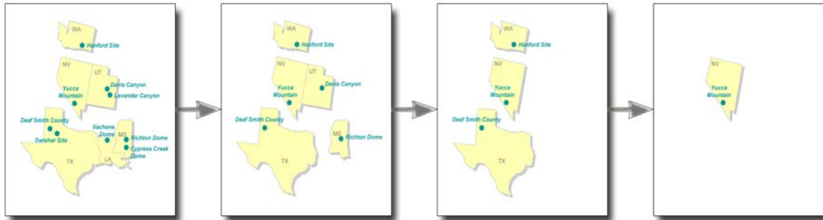
Abb. 60: Ablauf und Ergebnisse der in den 1980er Jahren schrittweise durchgeführten Reduzierung der Anzahl möglicher HAW-Endlagerstandorte in den USA (von links nach rechts: 1 – 1984, 2 – 1986, 3 und 4 – 1987; Quelle DOE)
