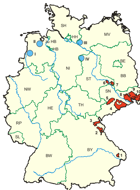
Abb. 53: Verteilung von potenziell für die HAW-Endlagerung geeigneten Vorkommen alternativer Wirtsgesteinstypen in Deutschland (Salinarstrukturen: I – Wahn, II – Zwischenahn, III – Gülze-Sumte, IV – Waddekath; Kristallinregionen: 1 – Saldenburg, 2 – nördlicher Oberpfälzer Wald, 3 – Fichtelgebirge, 4 – Graugneis Erzgebirge, 5 – Granulitgebirge, 6 – Pretzsch, 7 – Prettin, 8 – Pulsnitz, 9 – Radeberg-Löbau, 10 – Ostlausitz-Zawidow; BGR 2006)
