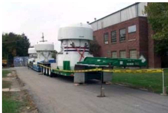
Abbildung 2-37: CNS 10-160B Transportcontainer für RH-TRU-Endlagerbehälter Der Untertage-Transport der Endlagerbehälter erfolgt mit Spezialfahrzeugen.
