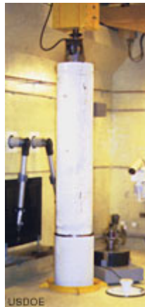
Abbildung 2-32: RH-TRU-Behälter für RH-TRU-Abfälle
