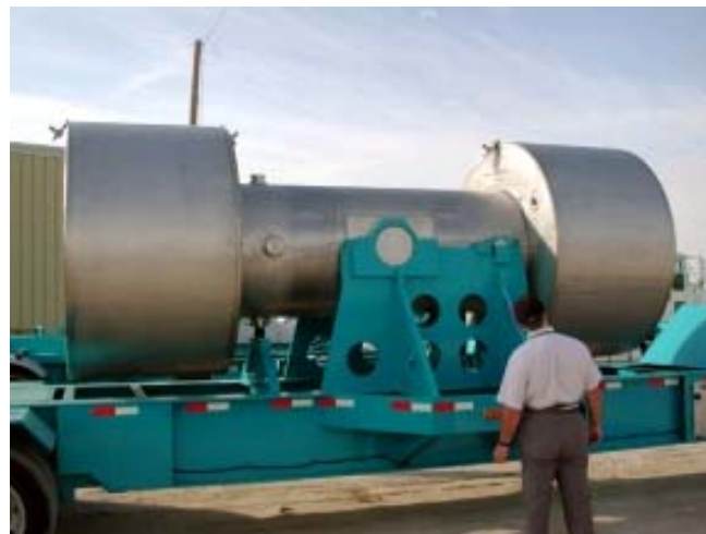
Abbildung 2-36: RH-72B Transportcontainer für den RH-TRU-Endlagerbehälter
