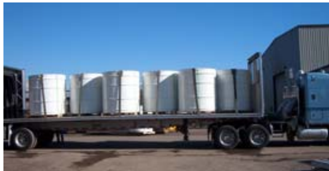
Abbildung 2-31: Ten Drum Overpacks (TDOP) mit CH-TRU-Abfällen auf einem Transportfahrzeug
