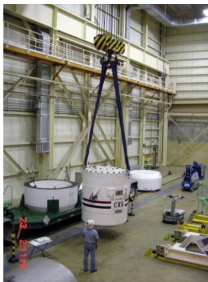
Abbildung 2-33: Handhabung eines CNS 10-160B Behälters mit RH-TRU-Abfallfässern im WIPP
