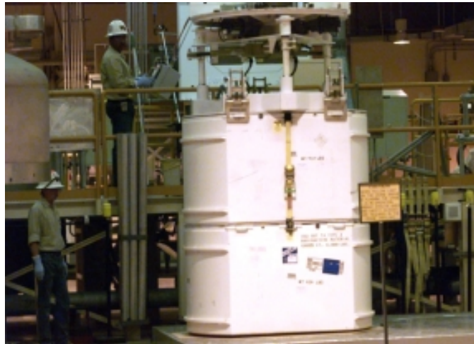
Abbildung 2-30: Zwei übereinandergestellte Standard Waste Boxes (SWB) mit CH-TRU-Abfällen nach Entladung aus einem Transportcontainer
