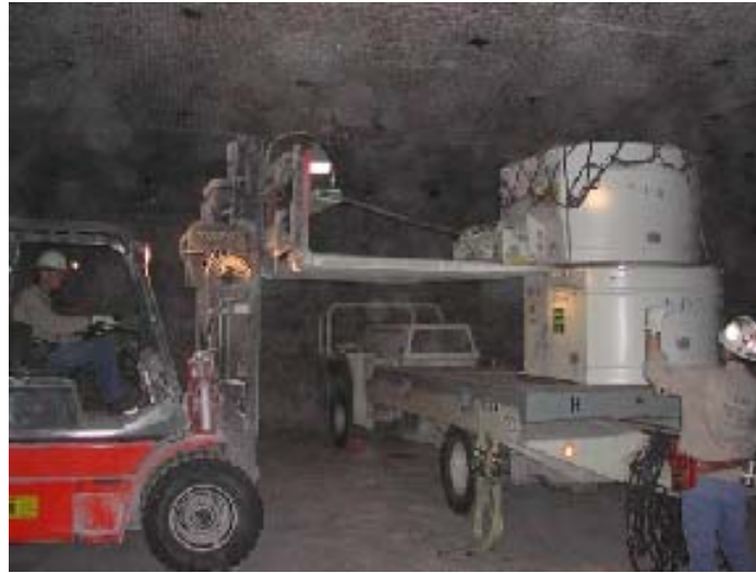
Abbildung 2-38: Entladung von CH-TRU-Behältern vom Transportfahrzeug
