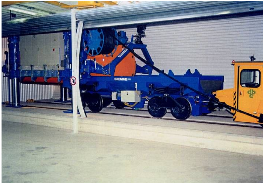
Abbildung 2-45: Einlagerungsvorrichtung für die Streckenlagerung von POLLUX-Behältern, Deutschland
