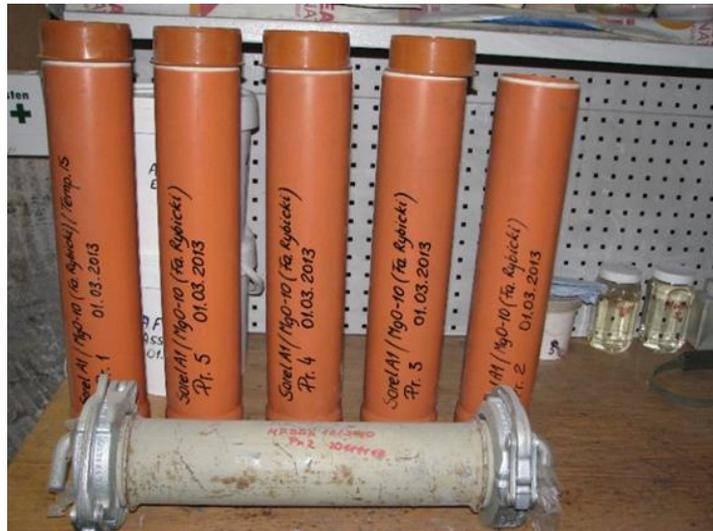
Abbildung 17: Beispiele für Laborproben aus Sorelbeton A1
