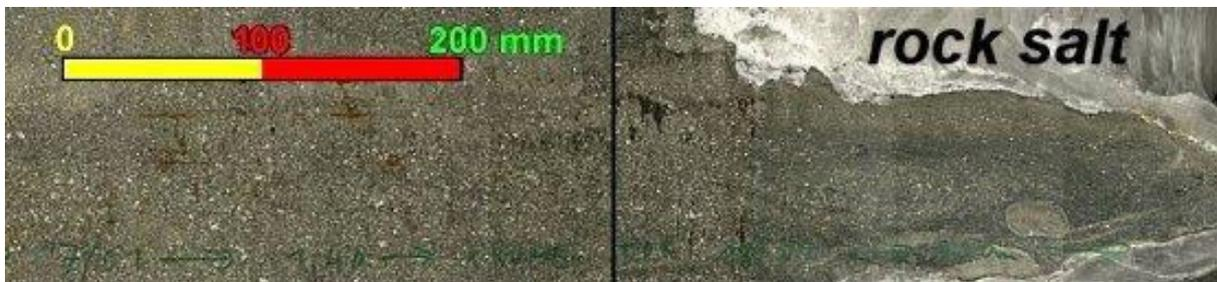
Abbildung 19: Bohrkernmaterial Salzbeton M2 – in situ Freifallversuch [PRE 2002]
