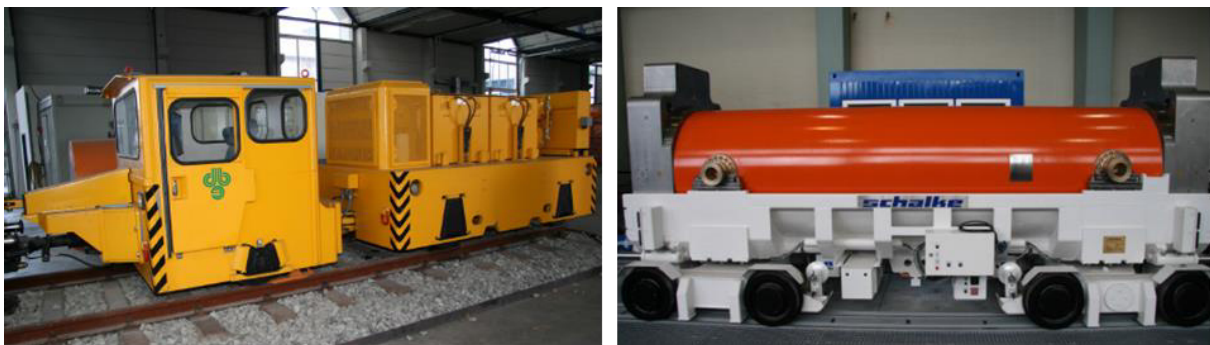
Abbildung 9: Batteriebetriebene Lokomotive mit Energieteil (links) und Plateauwagen mit Transferbehälter (rechts) (Filbert et al., 2010)
