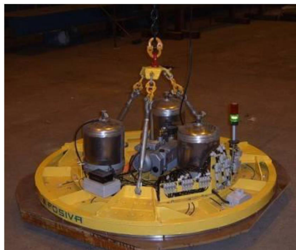
Abbildung 41: Autarke Saugglocke von POSIVA zum Anheben von Bentonitblöcken mit Hilfe eines
