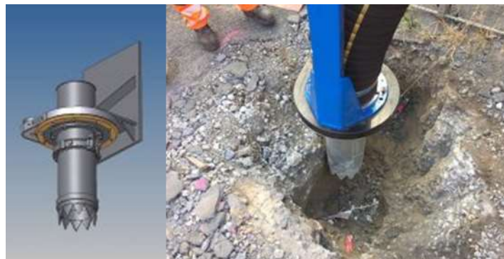
Abbildung 6-17: Drehrohr am Saugstutzen eines Saugbaggers (STW, 2020)
