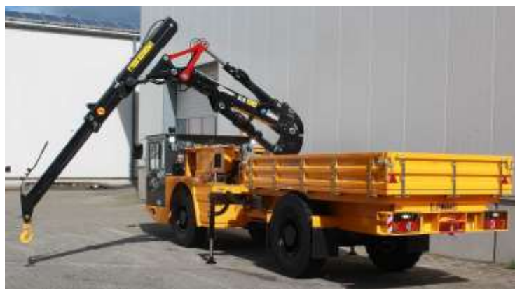
Abbildung 4-8: Universaltransportfahrzeug mit Kran und Ladefläche, Paus (2020a)
