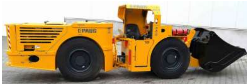
Abbildung 4-17: Sehr schmales Lade- und Transportfahrzeug PFL8, Paus (2020c)
