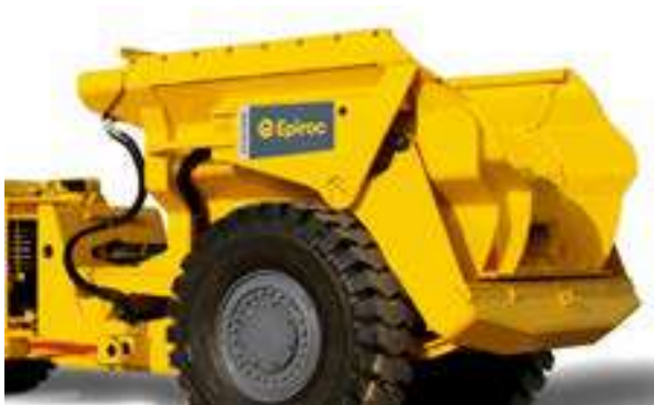
Abbildung 4-10: Muldenkipper Epiroc MT2200 mit Schubwand bis 10 m 3 , Epiroc (2020a)
