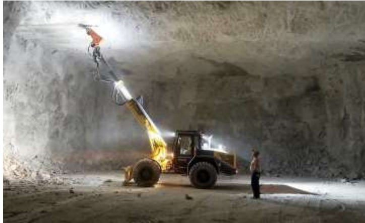
Abbildung 4-23: Beraubefahrzeug PAUS 1253 S10 mit Hydraulikhammer, Paus (2020d)
