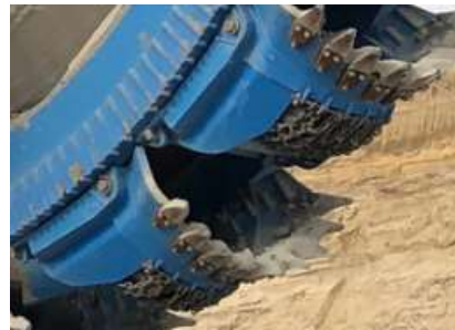
Abbildung 4-15: Schaufelboden aus Stahlketten, Thyssen (2020)
