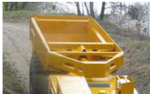
Abbildung 4-11: Muldenkipper Paus PMKS 12000 mit Schubwand für 14 m 3 , Paus (2020b)
