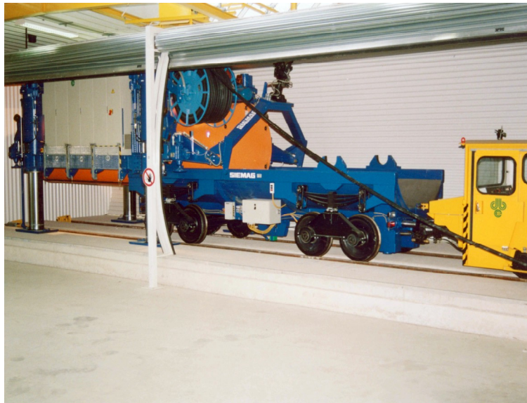
Abbildung 3-6: Erprobung der Transport- und Einlagerungstechnik für POLLUX-Behälter am Versuchsstand Peine
