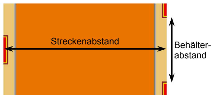
Abbildung 6-24: Modell zur Stabilitätsanalyse bei Streckenlagerung, Grundriss
