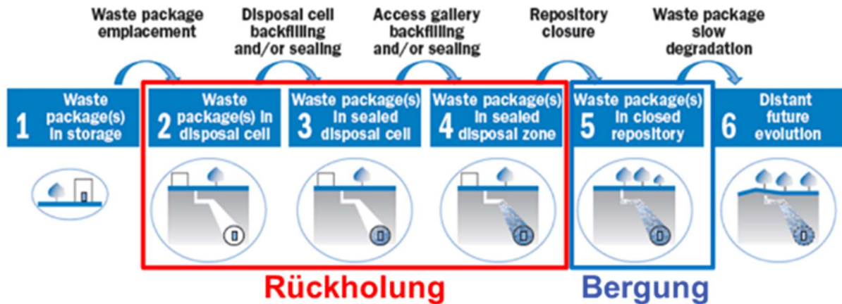
Abbildung 4-1: Typische Entwicklungsstufen eines Endlagers und Zuordnung der Rückholbarkeit und Bergung (NEA, 2011) und (Herold et al., 2018)
