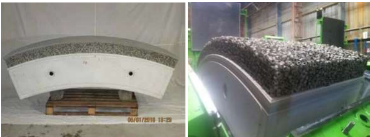
Abbildung 2-47: Vorgefertigte Bogensegmente ausgestattet mit einer Druckfläche mit kompressiblen Elementen (VMC-Segment) (Delay et al., 2019)
