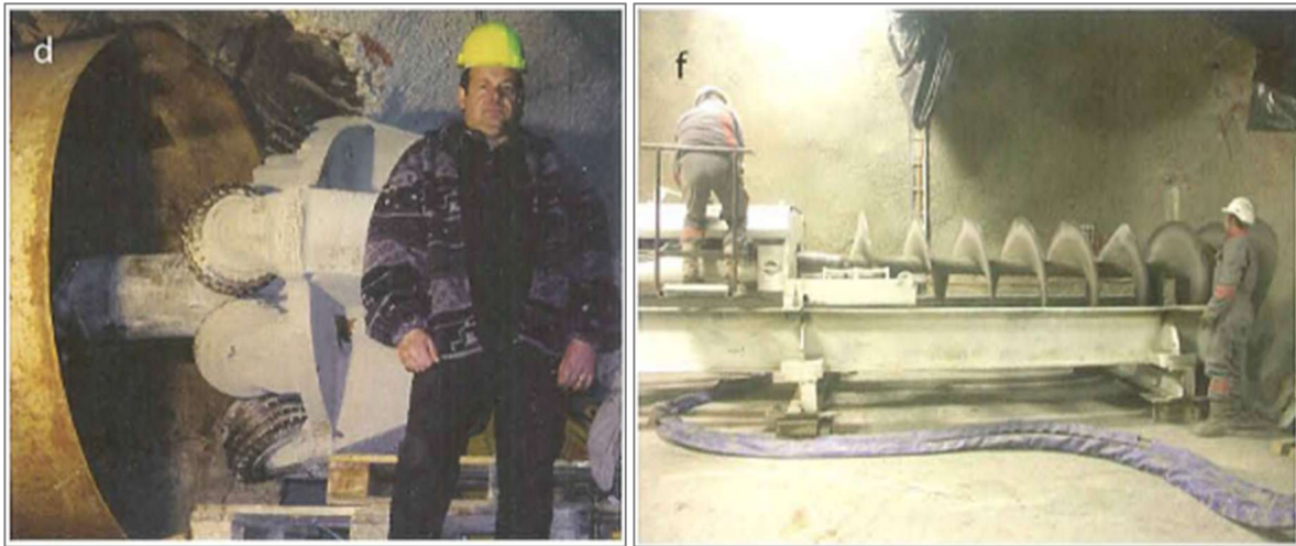
Abbildung 2-27: Links: Raise-Bohrer; Rechts: Schneckenbohrtechnik (Bossart & Thury, 2008)
