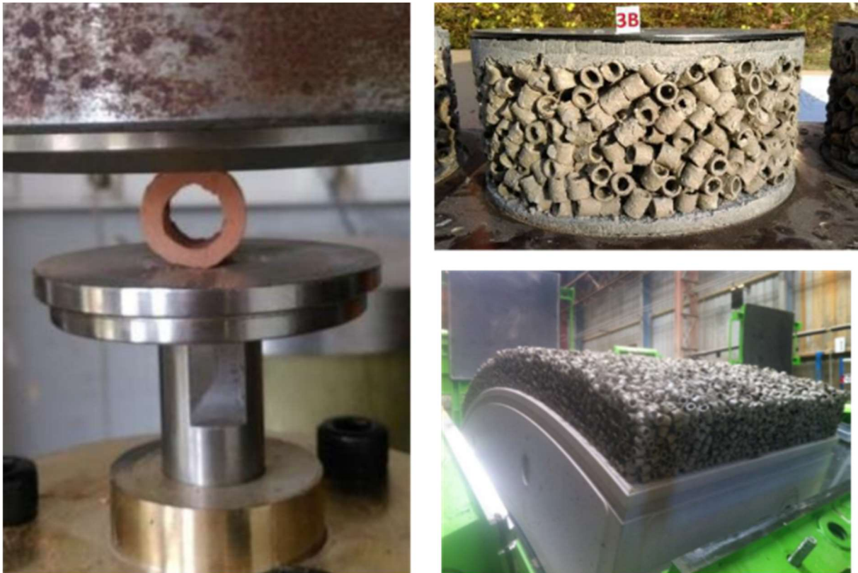
Abbildung 2-46: Tonröhrchen im Druckversuch (links), Probekörper aus vielen Tonröhrchen (rechts oben), Tübbing mit aufgebracht Schicht aus Tonröhrchen (rechts unten) (Zghondi et al., 2017) und (Ly, 2019)
