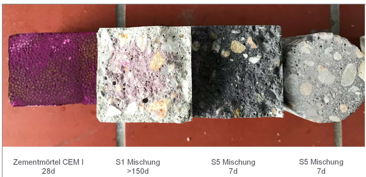
Abbildung 5-15: Phenolphthaleintest an Zementmörtel und LPC
